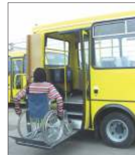
Լուսանկար 24. «Բոգդան» մակնիշի ավտոբուսում տեղադրված վերելակ
