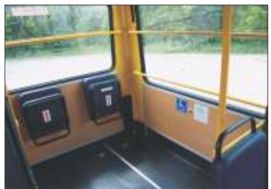
Լուսանկար 25. Ավտոբուսի սրահում հաշմանդամի համար նախատեսված տարածք
